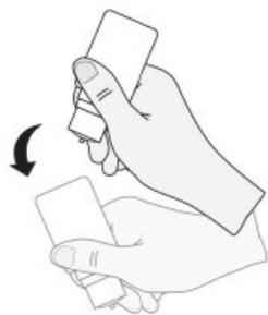
7) A ponta gotejadora foi desenhada para liberar uma única gota; portanto, **NÃO** alargue o furo da ponta gotejadora.
